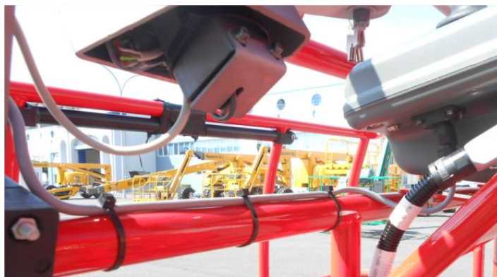
Konnektor (CN06) anbragt i støtteboksen (æstetisk og sikkert)
