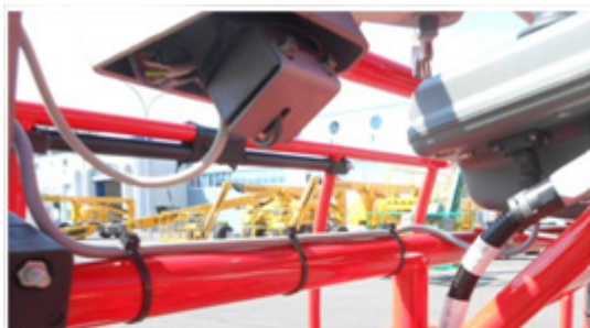
Connecteur (CN06) placé dans boîtier support (esthétique et protection)
