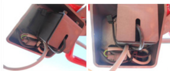
Connecteur (CN06) placé dans boîtier support (esthétique et protection)
