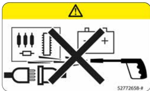
Figur 41: Mærkat - risiko for kortslutning
