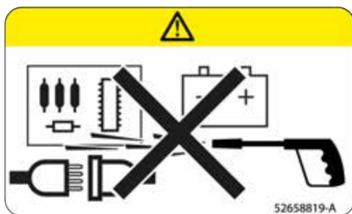
Figur 25: Mærkat - risiko for kortslutning
