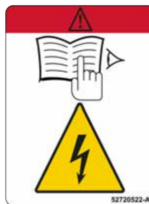
Figur 28: Mærkat - fare, risiko for livstruende elektrisk stød
