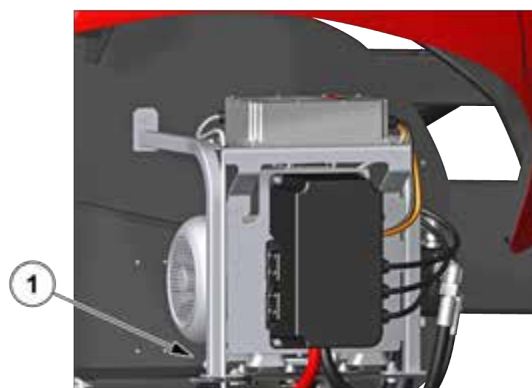
Figur 187: Kontrol af nødbetjeningsanordningerne fra platformen - første version
