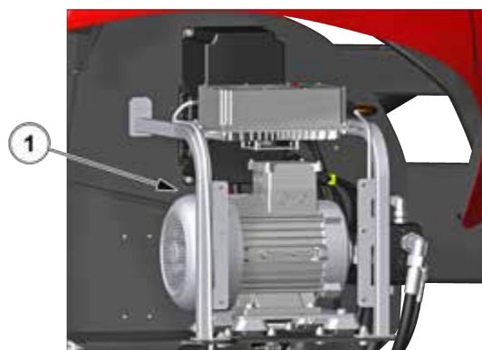
Figur 188: Kontrol af nødbetjeningsanordningerne fra platformen - anden version
