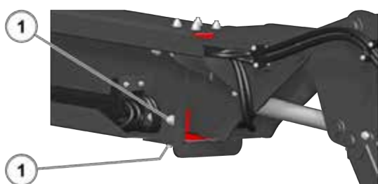
Figur 194: Kontrol af afstandsstykket på teleskoparmen 1 - 180 ATJE S1 - 180 ATJE RC S1
