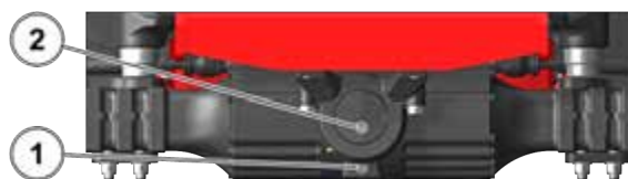
Figur 213: Udskiftning af olie i akslens differentiale
