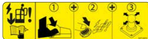
Figur 27: Mærkat - instruktioner for reservepumpe
