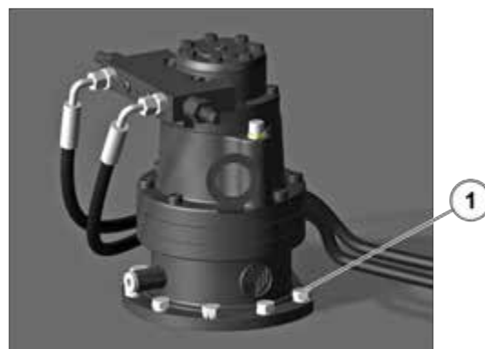
Figur 204: Kontrol af tilspændingen af motor til drejeskivens rotation
