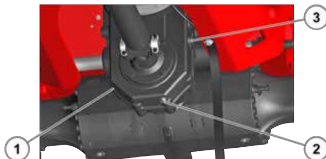
Figur 212: Udskiftning af gearkasseolien
