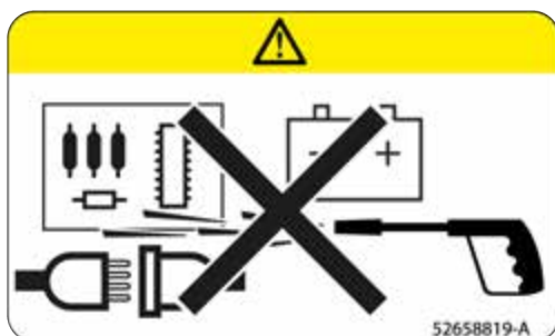
Figur 25: Mærkat - risiko for kortslutning
