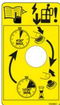
Figur 26: Mærkat - instruktioner for reservepumpe
