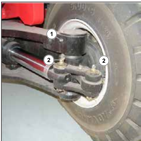
1.3.Smørenipler på bagakselsvinger (2 smørenipler).
