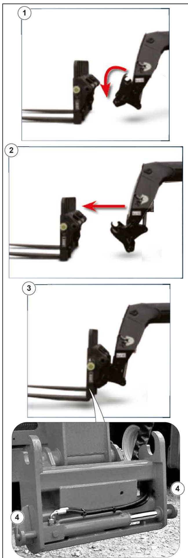
Figur 124: Genmontering af tilbehør med hydraulisk blok (valgfrit)
