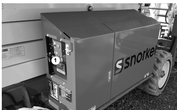
Figur 6.1 – Kontrolboksens placering, Jordposition
