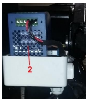
2 = Konverter 230V AC/12V DC
