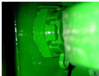
Fig. 68 Bolt – Bælter ikke strammet.
