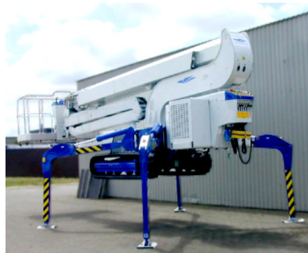
Fig. 58 Liften løftet ved hjælp af støttebenene
