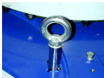
Fig. 10 Låsbolt løftet/støtteben ikke låst
