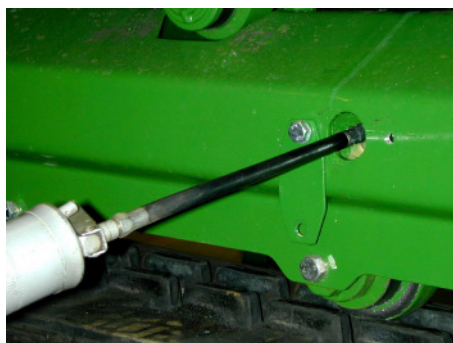
Fig. 67 Smørepistol for smørenippel på strammerullen.
