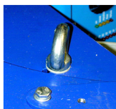
Fig. 9 Låsebolt sænket/støtteben låst
