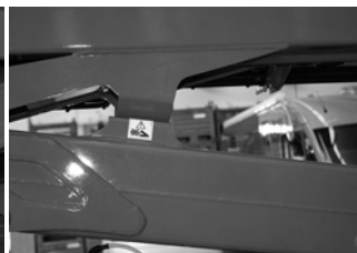
Fig. 98 Fare for skæring på maskine 3
