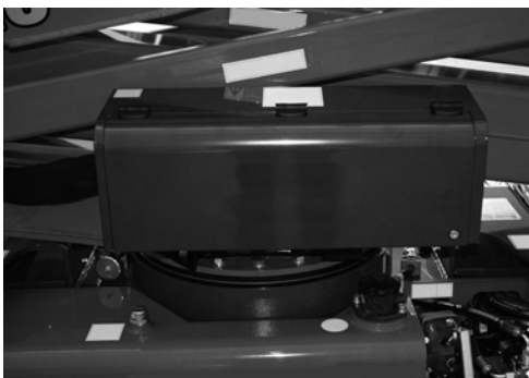
Fig. 111 Plade til luftdelens fordele
