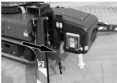
Fig. 152 Service-brugssæt fra jord
