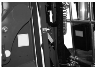
Fig. 96 Fare for skæring på maskine 1
