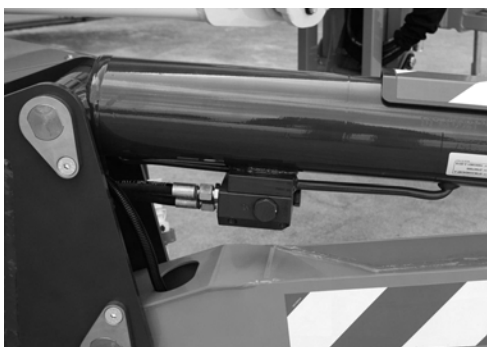
Fig. 10 Afbryderventil i sikkerhedsstiver
