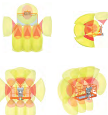
Figur 35. SkySense dækning niveau 2-områder (3– bar)
