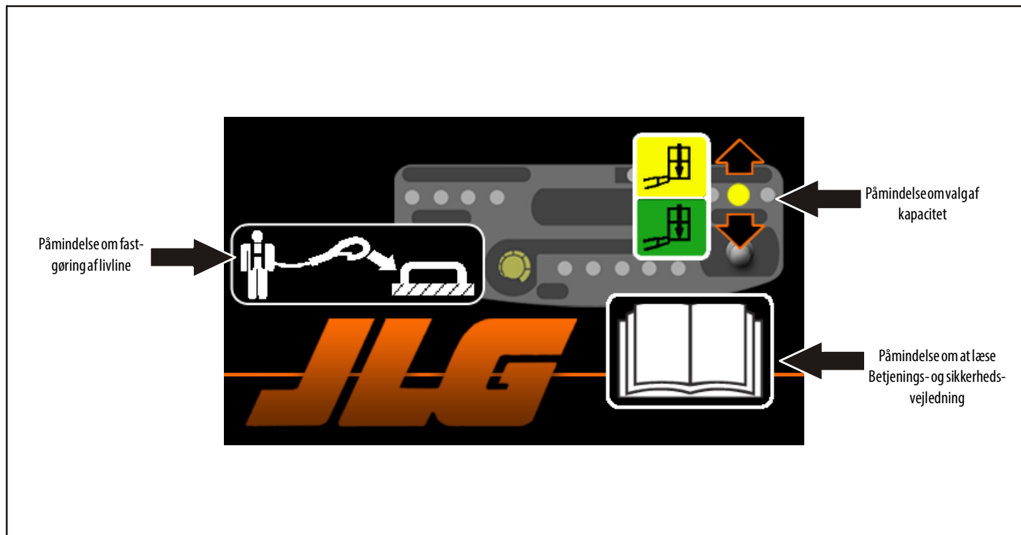
Figur 5-4. Introduktionsskærm ved opstart
