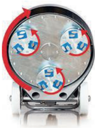
Figur 4-1 Illustrerer hvordan slibeskiverne bevæger sig i forhold til slibehovedet.
